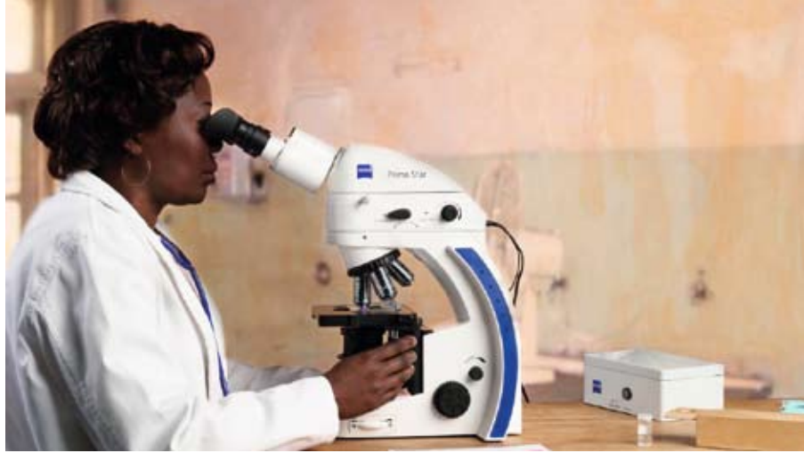
Das LED-basierte Fluoreszenzmikroskop Primo Star iLED vereinfacht die mikroskopische Erregeruntersuchung
