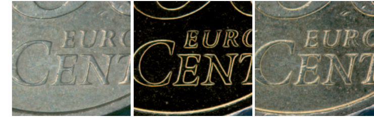
Auflicht-Hellfeld, Viertelkreis Auflicht-Dunkelfeld, Vollkreis Mischlicht
