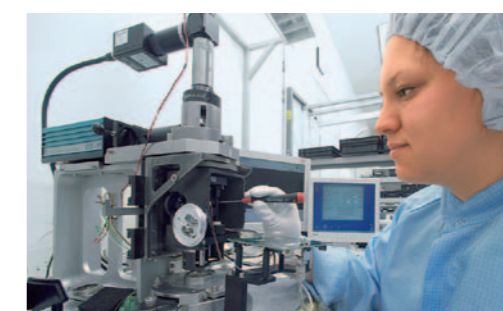
An der Pankrat-Justiervorrichtung wird der präzise Ablauf aller beweglichen Optikglieder programmiert. Rund 7000 Stützstellen werden per Computer dafür ausgewertet. Jedes einzelne Stereomikroskop erhält so eine eigene Korrektur – eben seine ganz individuelle Zoomsteuerkurve.
