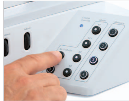
Durchlicht per Knopfdruck - über zwei Scrollrädchen passen Sie Helligkeit, Kontrast und Homogenität der Ausleuchtung individuell an.
