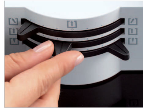
Mit drei Schiebereglern verändern Sie die Position des Spiegels zum Objekt.
